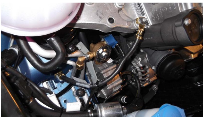
Obr. 3 : Umiestnenie regulátora tlaku AC R-01 s elektroventilom Valtek je volene tak aby nezamedzil prístup bežnému servisu a zároveň bol ľahký prístup k filtru kvapalnej fázy LPG ktorý je v elektroventile.
