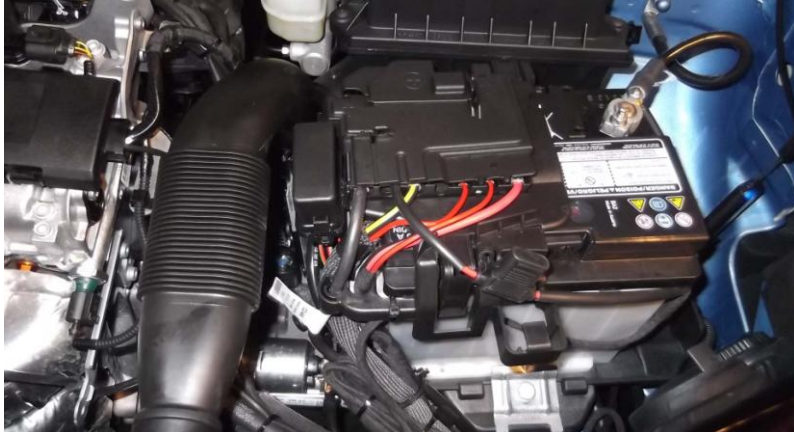
Obr. 1 : Umiestnenie poistky systému musí byť na viditeľnom ľahko prístupnom mieste, najčastejšie pri akumulátore.
