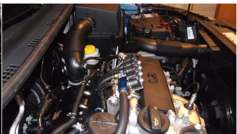
Obr. 4 : vstrekovače by mali byť v zvislej polohe alebo takto naklonené, predíde sa zbytočným poruchám.
