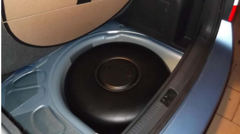
Obr. 7 : 46l nádrž maximálne vyplní priestor. Z bezpečnostného hladiska sa plní na 80% svojho objemu a zabezpečí to viacúčelový ventil umiestni to pod krytom nádrže
